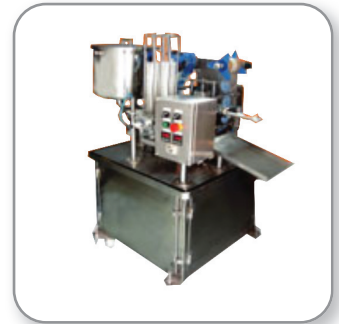
• เครื่องบรรจุและปิดผนึกด้วยฟิล์มระบบอัตโนมัติ ROTARY Capability : 10-18 ครั้ง/นาที (ขึ้นอยู่กับปริมาณบรรจุ)
