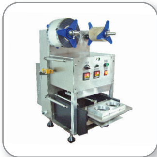
• เครื่องซีลปิดผนึกถาดด้วยฟิล์มระบบกึ่งอัตโนมัติ SEMI- Capability : 6-10 ครั้ง/นาที (ขึ้นอยู่กับปริมาณบรรจุ)
